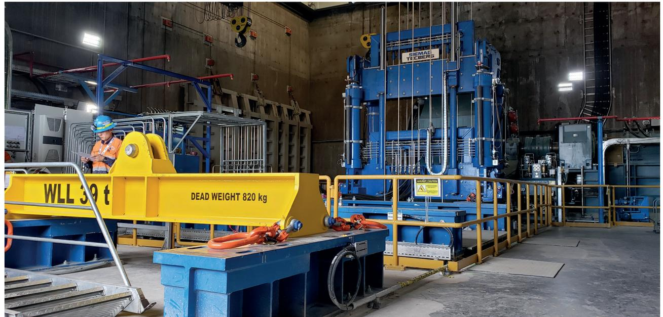
Установка 6-канатного подъемно-зажимного устройства в стволе 2 рудника Оуу Толгой.
