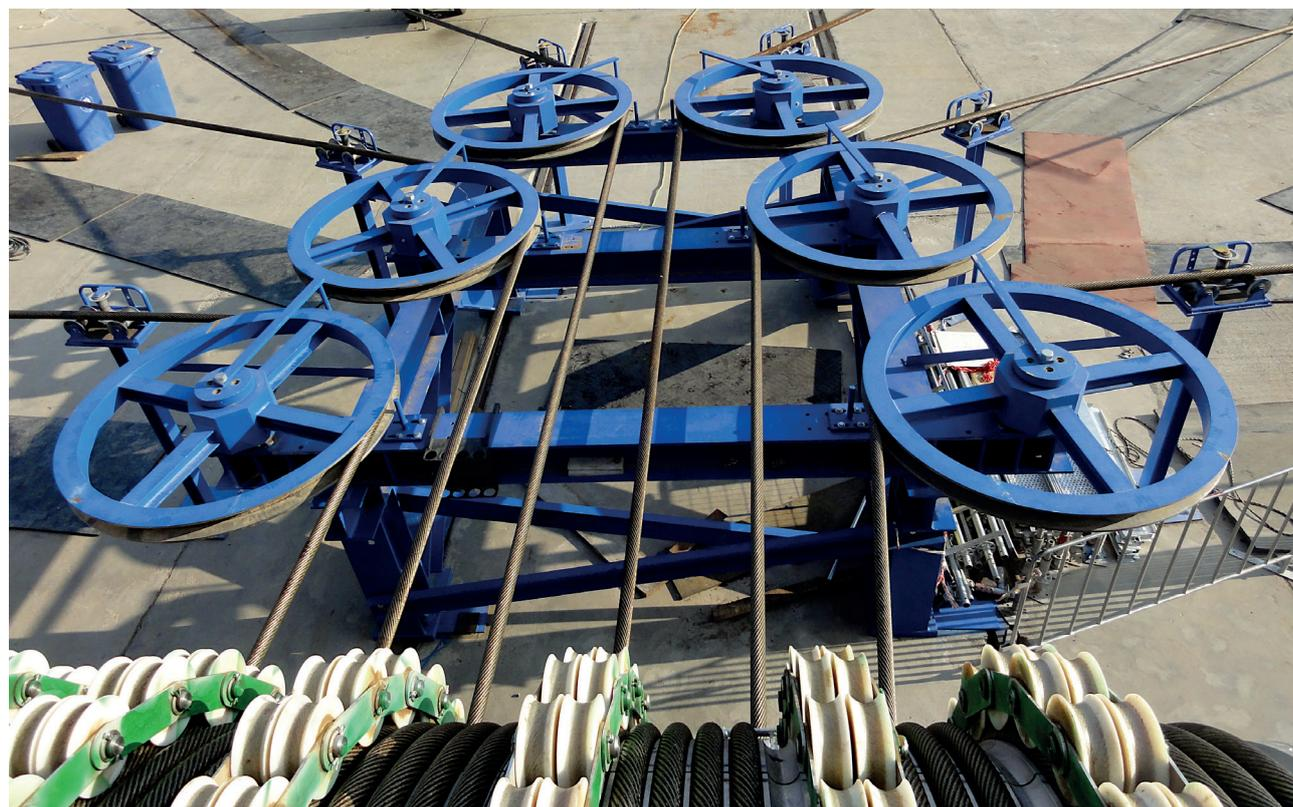
Вид с фрикционной лебедки на горизонтальные отклоняющие шкивы с протянутыми канатами.
