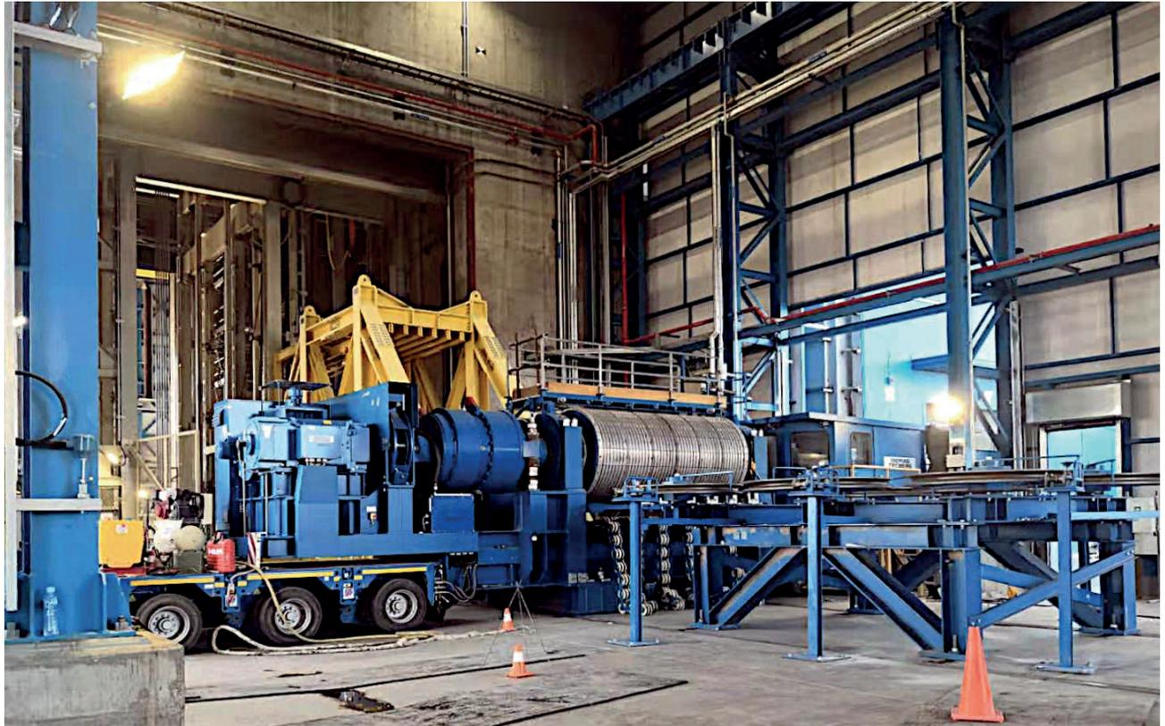
Подготовка к навеске канатов в створе 2 при помощи мобильной фрикционной лебедки и горизонтальных отклоняющих шкивов.
